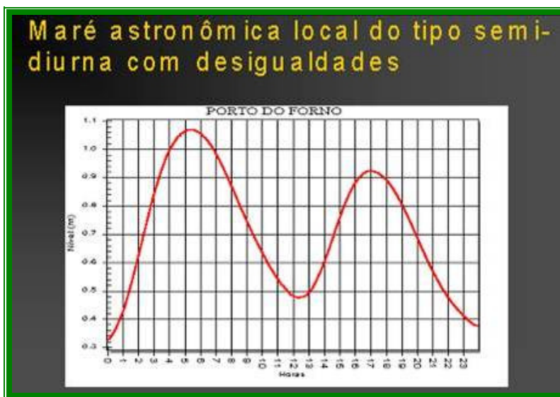
FIGURA 1.1. – Perfil de variação de maré semidiurna no Porto do Forno Os registros do Porto do Forno remontam os últimos 18 anos e indicam que o nível do mar permaneceu estável neste período, registrando apenas uma variação anormal no período do acontecimento do tsunami que atingiu a Ásia em 2007.
