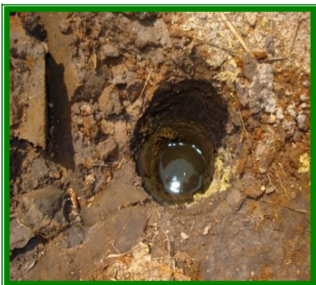
Foto 1.9. – Furo de tradagem em Gleissolo Tiomórfico. As cores amarelas são indícios da presença de compostos de enxofre. O lençol freático está a 36cm de profundidade.UTM 159133/7478223.
