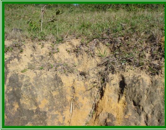
Foto 1.3. – Argissolo Amarelo A moderado, textura média/argilosa, cascalhento em superfície. Área frontal ao aeroporto. UTM 195339/7479141.
