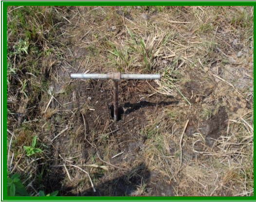
Foto 1.1. - Aspecto de furo de tradagem atingindo 1,80m de profundidade. Coordenadas UTM 195124/7478299.
